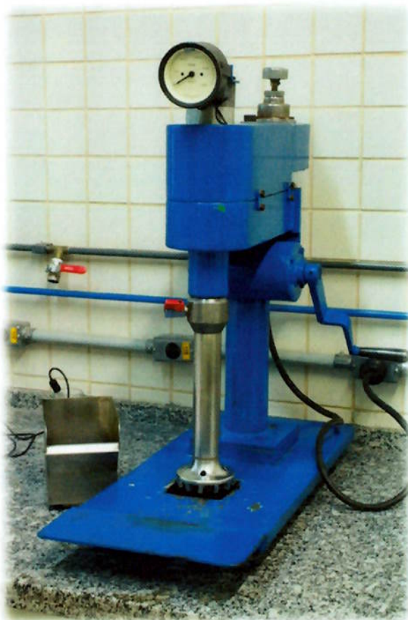
Figura 3: Célula de flotação em bancada utilizada nos ensaios.
